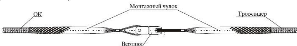
Рис. 2 Схема установки компенсатора кручения (вертлюга)
