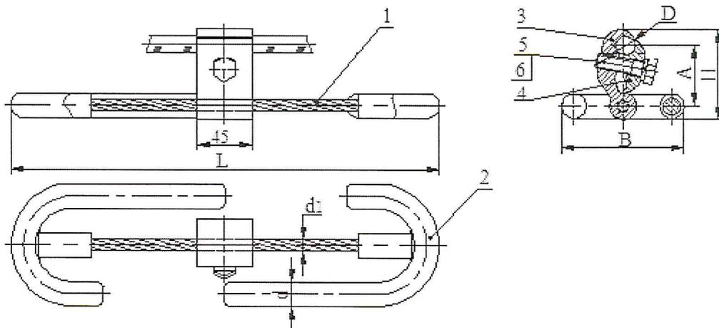
1- Упругий элемент, 2- Груз, 3- Корпус, 4- Плашка, 5- Болт, 6- Шайба.
