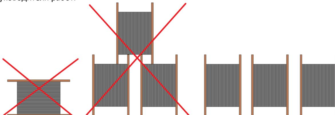
Рис. 1 Хранение барабанов с оптическим кабелем
