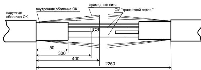
4. Монтаж ОК с алюмополиэтиленовой оболочкой и ОК со стальной гофрированной лентой без внутренней оболочки
