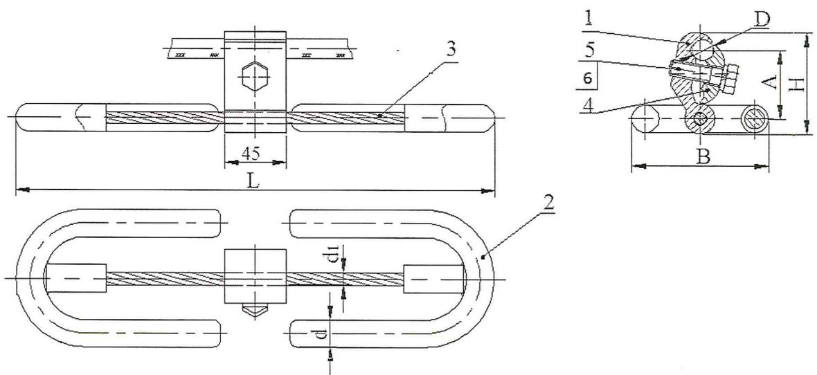
1- Корпус, 2- Груз, 3- Упругий элемент, 4-Плашка, 5- Болт, 6- Шайба
