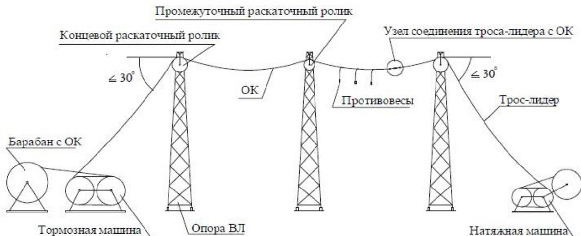
Рис. 3 Схема раскатки ОК
