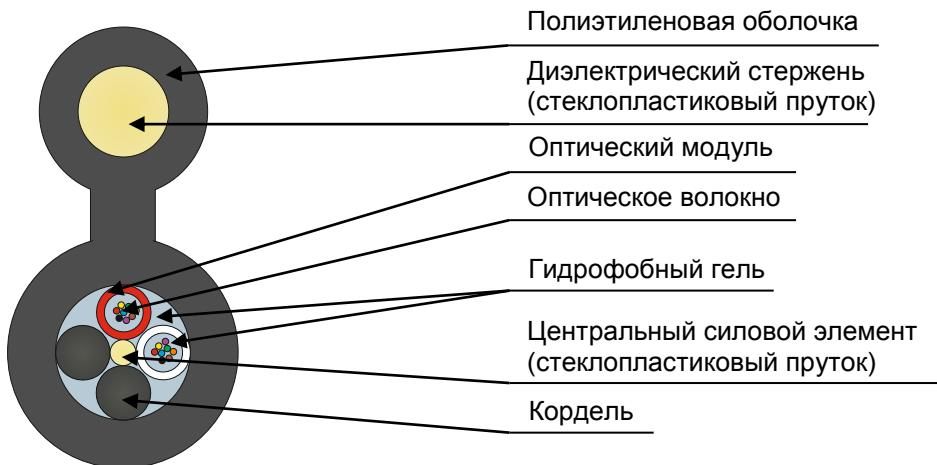
Кабель содержит сердечник модульной конструкции с центральным силовым элементом из диэлектрического стержня, вокруг которого скручены оптические модули со свободноложенными волокнами. Свободное пространство в оптических модулях и в сердечнике кабеля заполнено гидрофобным гелем. В качестве подвесного элемента используется диэлектрический стержень. На сердечник и подвесной элемент накладывается оболочка из полиэтилена средней плотности.
