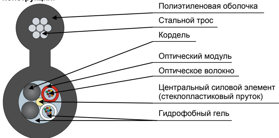
Кабель содержит сердечник модульной конструкции с центральным силовым элементом из диэлектрического стержня, вокруг которого скручены оптические модули со свободноложенными волокнами. Свободное пространство в оптических модулях и в сердечнике кабеля заполнено гидрофобным гелем. В качестве подвесного элемента используется стальной трос. На сердечник и подвесной элемент накладывается оболочка из полиэтилена средней плотности.
