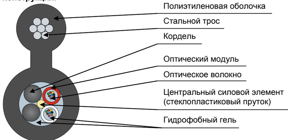
Кабель содержит сердечник модульной конструкции с центральным силовым элементом из диэлектрического стержня, вокруг которого скручены оптические модули со свободно уложенными волокнами. Свободное пространство в оптических модулях и в сердечнике кабеля заполнено гидрофобным гелем. В качестве подвесного элемента используется стальной трос. На сердечник и подвесной элемент накладывается оболочка из полиэтилена средней плотности.
