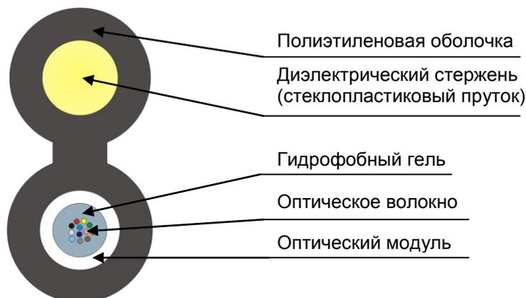
Кабель содержит оптический модуль со свободно уложенными волокнами. Свободное пространство в оптическом модуле заполнено гидрофобным гелем. В качестве подвесного элемента используется диэлектрический стержень. На оптический модуль и подвесной элемент накладывается оболочка из полиэтилена средней плотности.
