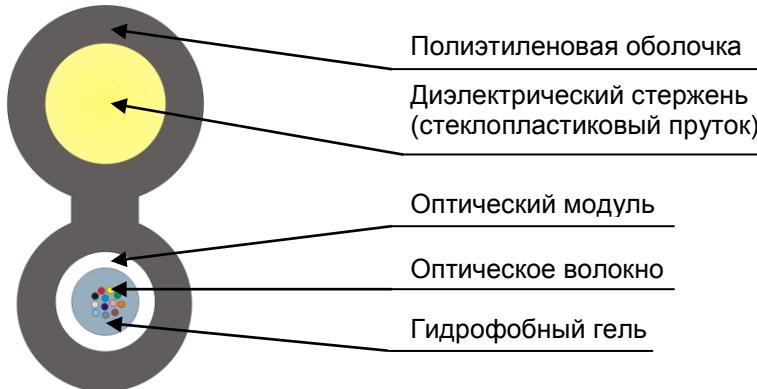
Кабель содержит оптический модуль со свободно уложенными волокнами. Свободное пространство в оптическом модуле заполнено гидрофобным гелем. В качестве подвесного элемента используется диэлектрический стержень. На оптический модуль и подвесной элемент накладывается оболочка из полиэтилена средней плотности.
