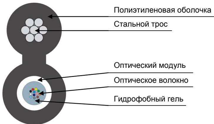
Кабель содержит оптический модуль со свободно уложенными волокнами. Свободное пространство в оптическом модуле заполнено гидрофобным гелем. В качестве подвесного элемента используется стальной трос. На оптический модуль и подвесной элемент накладывается оболочка из полиэтилена средней плотности.
