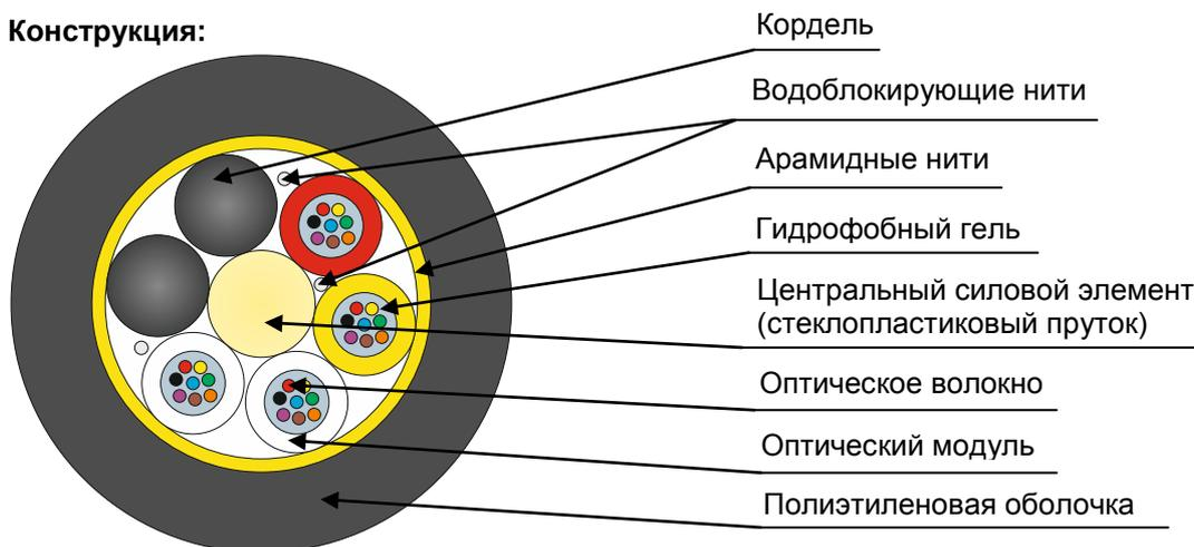
Кабель содержит сердечник модульной конструкции с центральным силовым элементом из диэлектрического стержня со спирально наложенной водоблокирующей нитью, вокруг которого скручены оптические модули со свободно уложенными волокнами. Сердечник скреплен двумя обмоточными нитями с водоблокирующим свойством. На сердечник спирально накладываются арамидные нити и оболочка из полиэтилена средней плотности.
