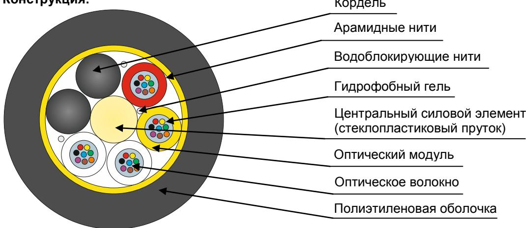
Кабель содержит сердечник модульной конструкции с центральным силовым элементом из диэлектрического стержня со спирально наложенной водоблокирующей нитью, вокруг которой скручены оптические модули со свободноложенными волокнами. Сердечник скреплен двумя обмоточными нитями с водоблокирующим свойством. На сердечник спирально накладываются арамидные нити и оболочка из полиэтилена средней плотности.
