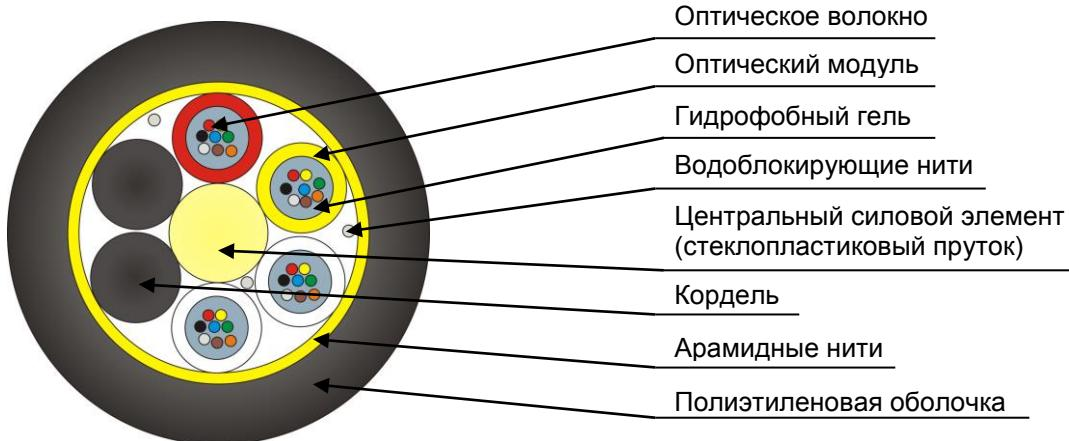
Кабель содержит сердечник модульной конструкции с центральным силовым элементом из диэлектрического стержня со спирально наложенной водоблокирующей нитью, вокруг которого скручены оптические модули со свободно уложенными волокнами. Свободное пространство в оптических модулях заполнено гидрофобным гелем. Сердечник скреплен обмоточными нитями с водоблокирующим свойством. На сердечник спирально накладываются арамидные нити и оболочка из полиэтилена средней плотности.
