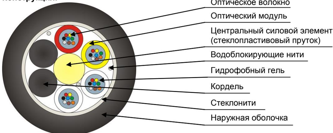
Кабель содержит сердечник модульной конструкции с центральным силовым элементом из диэлектрического стержня со спирально наложенной водоблокирующей нитью, вокруг которого скручены оптические модули со свободно уложенными волокнами. Свободное пространство в оптических модулях заполнено гидрофобным гелем. Сердечник скреплен двумя обмоточными нитями с водоблокирующим свойством. На сердечник спирально накладываются стеклонити и оболочка из полиэтилена средней плотности.
