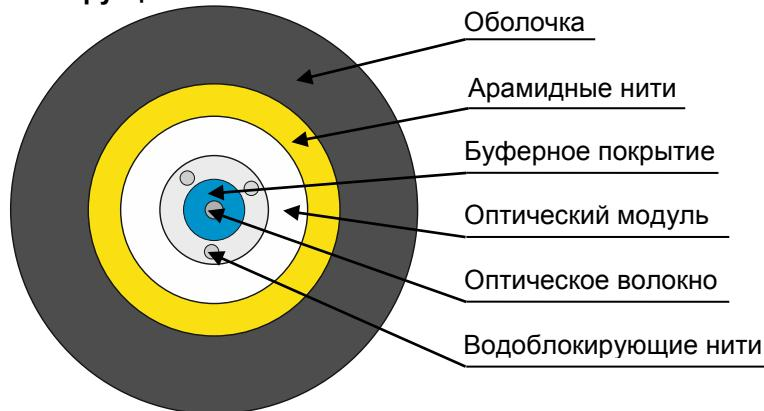
Кабель содержит одно оптическое волокно в буферном покрытии. Оптическое волокно вместе со свободно уложенными водоблокирующими нитями находится в оптическом модуле. Поверх модуля спирально накладываются упрочняющие арамидные нити и оболочка из полимерной композиции, не распространяющей горение, не содержащей галогенов с низким дымоудалением. Оболочка кабеля изготавливается черного цвета, стойкой к ультрафиолетовому излучению.
