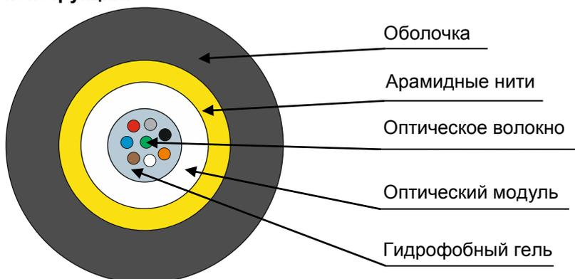
Кабель содержит оптический модуль со свободно расположенными волокнами. Свободное пространство в оптическом модуле заполнено гидрофобным гелем. Поверх модуля спирально накладываются упрочняющие арамидные нити и оболочка из полимерной композиции, не распространяющей горение, не содержащей галогенов с низким дымовыделением. Оболочка кабеля изготавливается черного цвета, стойкой к ультрафиолетовому излучению.
