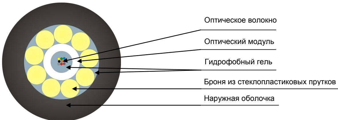
Кабель содержит центральный оптический модуль со свободно уложенными волокнами. Свободное пространство в оптическом модуле заполнено гидрофобным гелем. На центральный оптический модуль спирально накладывается броня из стеклопластиковых прутков. Свободное пространство между прутками заполнено гидрофобным гелем. На броню накладывается оболочка из полимерной композиции, не распространяющей горение, не содержащая галогенов с низким дымовыделением.
