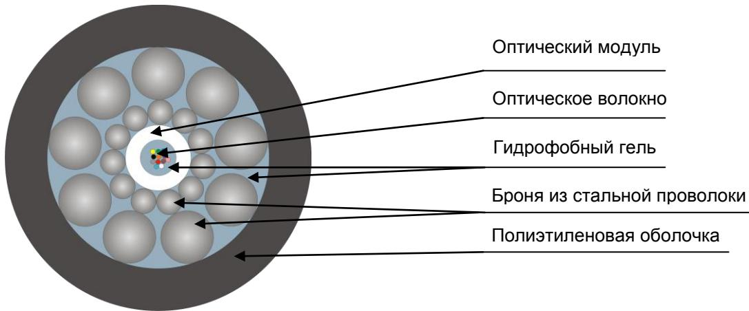
Кабель содержит центральный оптический модуль со свободно уложенными волокнами. Свободное пространство в оптическом модуле заполнено гидрофобным гелем. На центральный оптический модуль спирально накладываются два слоя брони из стальных проволок. Свободное пространство между проволоками заполнено гидрофобным гелем. На броню накладывается оболочка из полиэтилена средней плотности.
