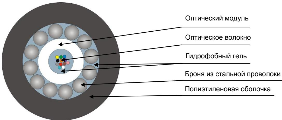
Кабель содержит центральный оптический модуль со свободно уложенными волокнами. Свободное пространство в оптическом модуле заполнено гидрофобным гелем. На центральный оптический модуль спирально накладывается броня из стальных проволок. Свободное пространство между проволоками заполнено гидрофобным гелем. На броню накладывается оболочка из полиэтилена средней плотности.
