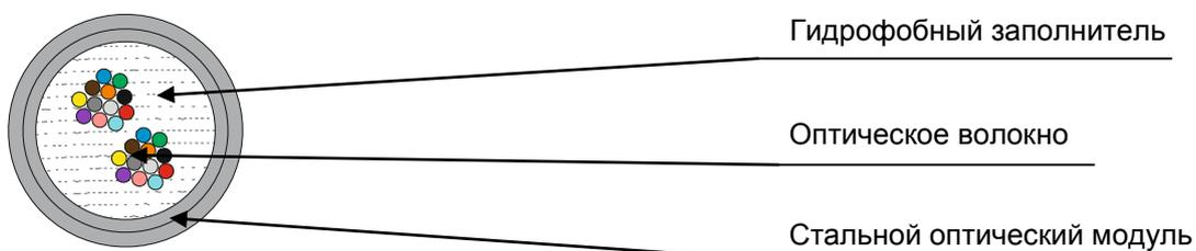
Стальной оптический модуль содержит свободно уложенные волокна. Оптические волокна в модуле сгруппированы в пучки. Каждый пучок волокон имеет обмотку цветной синтетической нити. Свободное пространство в оптическом модуле заполнено гидрофобным гелем.
