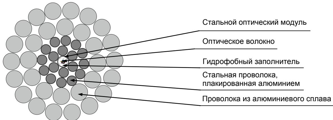
Кабель содержит центральный стальной оптический модуль со свободно уложенными волокнами. Свободное пространство в оптическом модуле заполнено гидрофобным гелем. На центральный оптический модуль спирально накладываются четыре повива из армирующих проволок.
