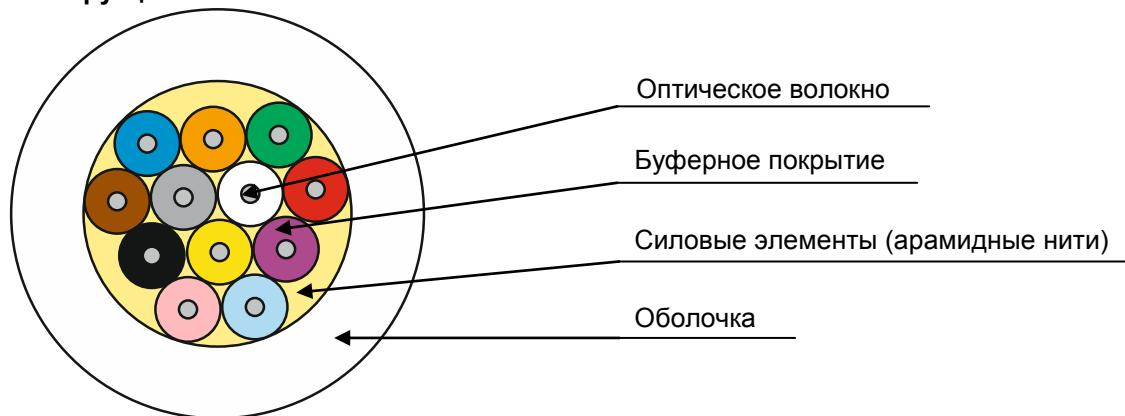
Кабель содержит пучок оптических волокон в буферном покрытии, на который наложен слой упрочняющих арамидных нитей. Оболочка кабеля изготавливается из полимерной композиции, не распространяющей горение, с пониженным дымо- и газовыделением, не выделяющей коррозионно-активные и газообразные продукты при горении и тлении, с низкой токсичностью продуктов горения. Оболочка кабеля для внутренней прокладки изготавливается белым цветом.
