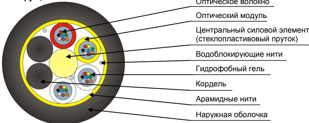
Кабель содержит сердечник модульной конструкции с центральным силовым элементом из диэлектрического стержня со спирально наложенной водоблокирующей нитью, вокруг которого скручены оптические модули со свободноложенными волокнами. Свободное пространство в оптических модулях заполнено гидрофобным гелем. Сердечник скреплен двумя обмоточными нитями с водоблокирующим свойством. На сердечник спирально накладываются арамидные нити и оболочка из полиэтилена средней плотности.
