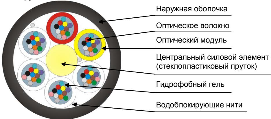
Кабель содержит сердечник модульной конструкции с центральным силовым элементом из диэлектрического стержня, вокруг которого скручены оптические модули со свободноложенными волокнами. Свободное пространство в оптических модулях заполнено гидрофобным гелем. Сердечник скреплен обмоточными нитями с водоблокирующими свойствами. На сердечник накладывается оболочка из полимерной композиции, не распространяющей горение, не содержащая галогенов с низким дымоудалением.
