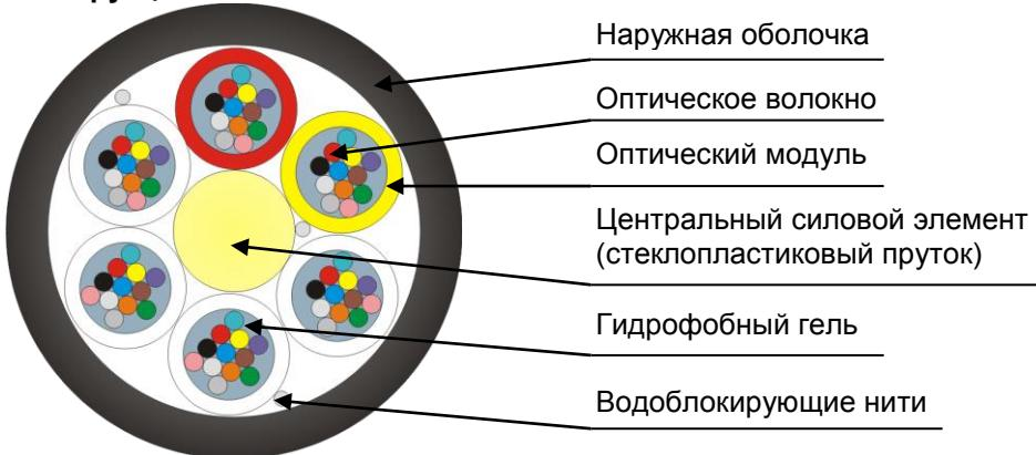
Кабель содержит сердечник модульной конструкции с центральным силовым элементом из диэлектрического стержня, вокруг которого скручены оптические модули со свободно уложенными волокнами. Свободное пространство в оптических модулях заполнено гидрофобным гелем. Сердечник скреплен обмоточными нитями с водоблокирующими свойством. На сердечник накладывается оболочка из полиэтилена средней плотности.
