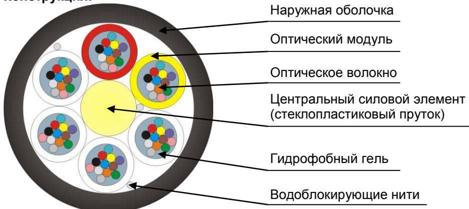
Кабель содержит сердечник модульной конструкции с центральным силовым элементом из диэлектрического стержня, вокруг которого скручены оптические модули со свободно уложенными волокнами. Свободное пространство в оптических модулях заполнено гидрофобным гелем. Сердечник скреплен двумя обмоточными водоблокирующими нитями. На сердечник накладывается оболочка из полиэтилена средней плотности.
